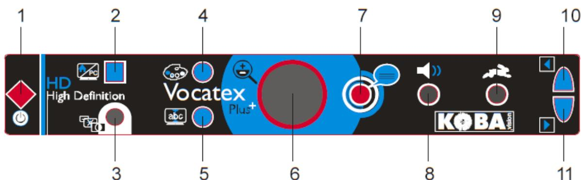
Un tableau de **gros boutons** permet d'accéder aux principales fonctions de l'appareil. Sur la **gauche** du tableau, les boutons concernent principalement la **vidéo-loupe**. Sur la **droite** du tableau, les boutons concernent la **machine à lire**.
